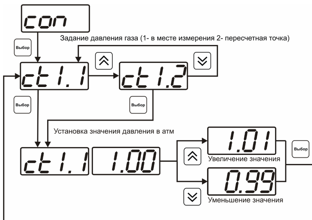
Рисунок 6.13 Задание давления анализируемого газа
